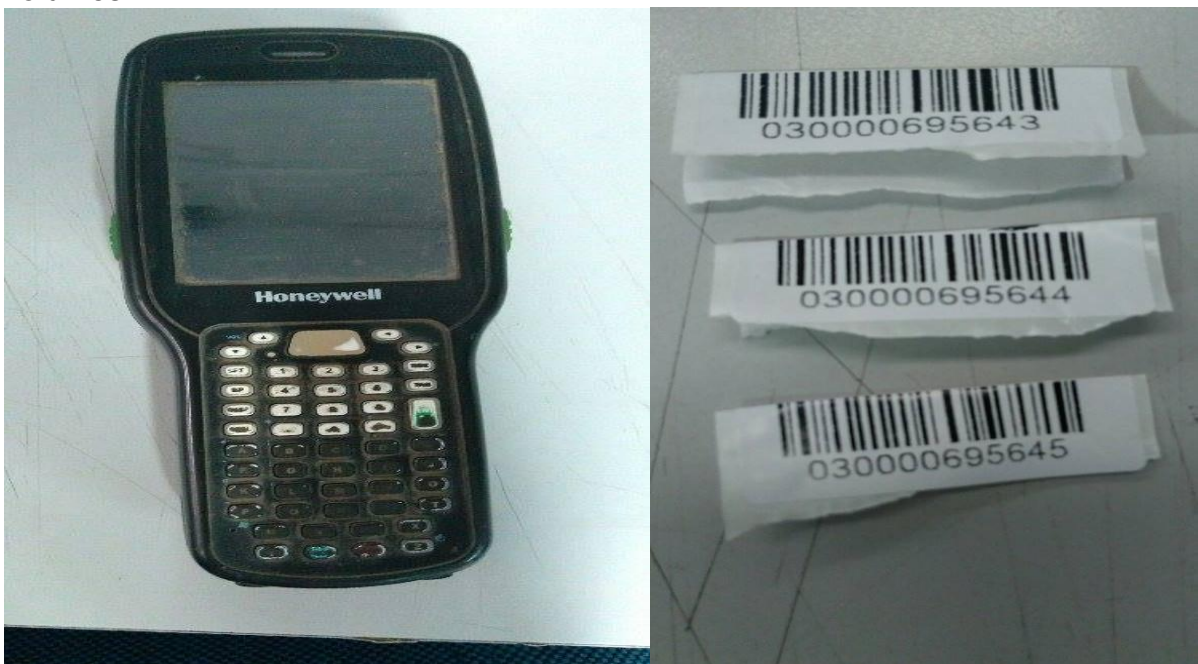
Figura 10 Coletor para a conferência e código de barra para a identificação dos volumes.
