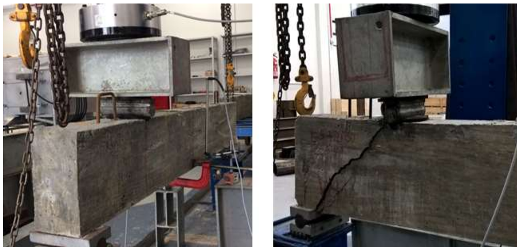
Figura 10 - (A) Viga antes do ensaio; (B) Viga após colapso.
