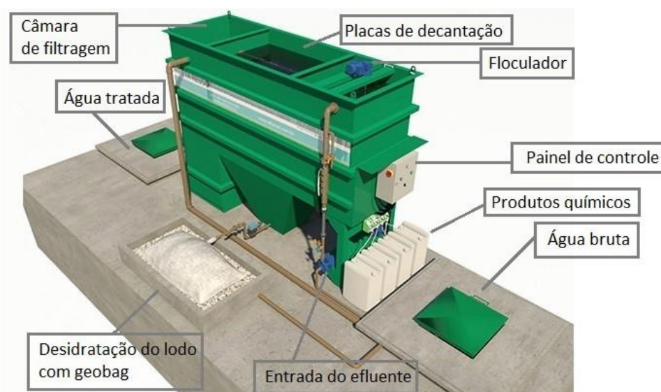
Figura 3. ETA de reuso com reservatórios enterrados, modelo com vazões de 800 a 5.000 l/h.
