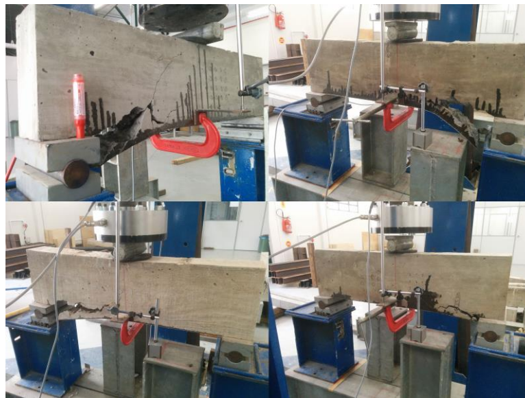
Figura 10: Ruptura de vigas reforçadas
