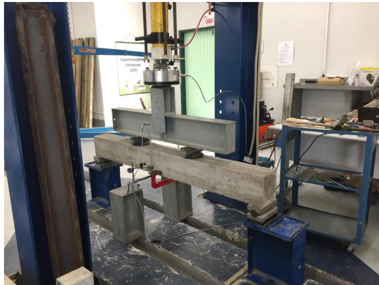
Figura 05: Realização do ensaio de flexão 4 pontos.
