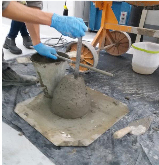
Figura 6 - Abatimento por tronco de cone
