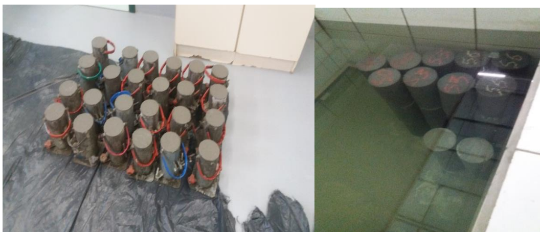
Figura 7 – a) Corpos de prova moldados b) Corpos de prova em cura
