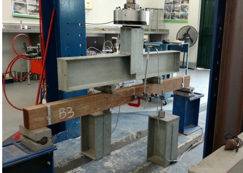
Figura 5 – Ensaio de Flexão Estática a Quatro Pontos
