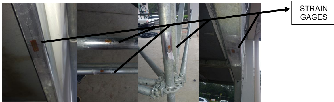
Figura 04: módulo com Strain Gages posicionados.
