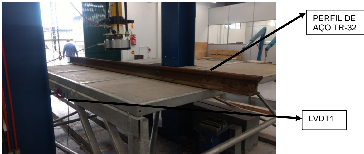
Figura 06: aplicação de carga linear (kN/m).
