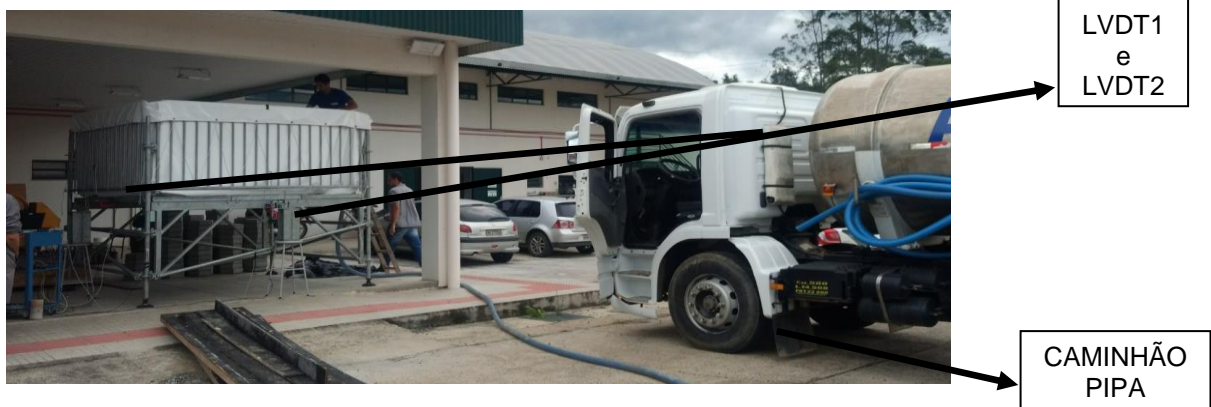
Figura 05: prova de carga com água ( \text{kN/m}^2 ).
