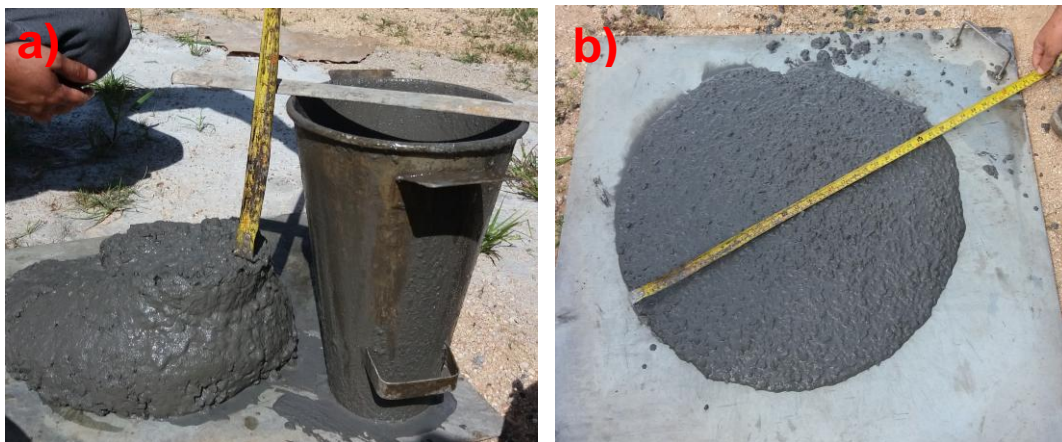
Figura 03: a) Ensaio de “Slump Test”; b) Ensaio de “Slump Flow Test”.
