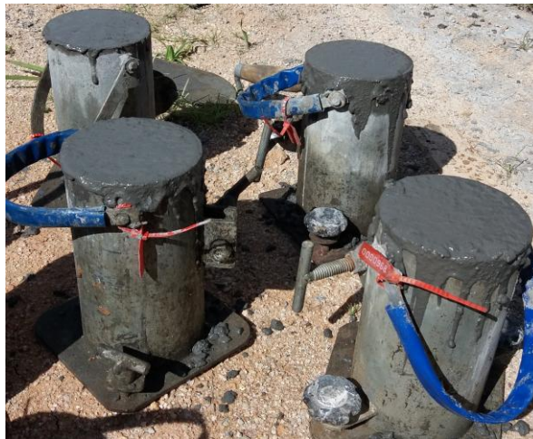
Figura 05: Moldagem dos corpos de prova.
