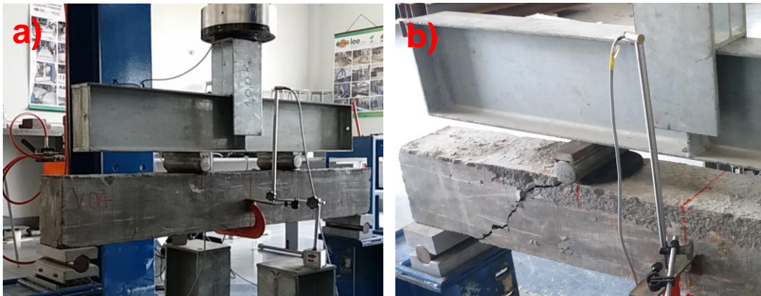
Figura 08: a) Viga montada para o ensaio; b) Viga rompida.
