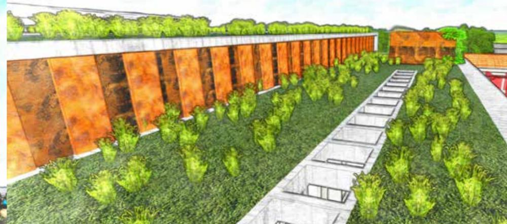
As coberturas de concreto vão contar com vegetação para melhorar o conforto térmico dentro da edificação. As diferentes alturas nos volumes possibilitam a utilização de brises para ventilação e iluminação natural. Uma abertura na laje de concreto permite também a ventilação e entrada de luz natural.
