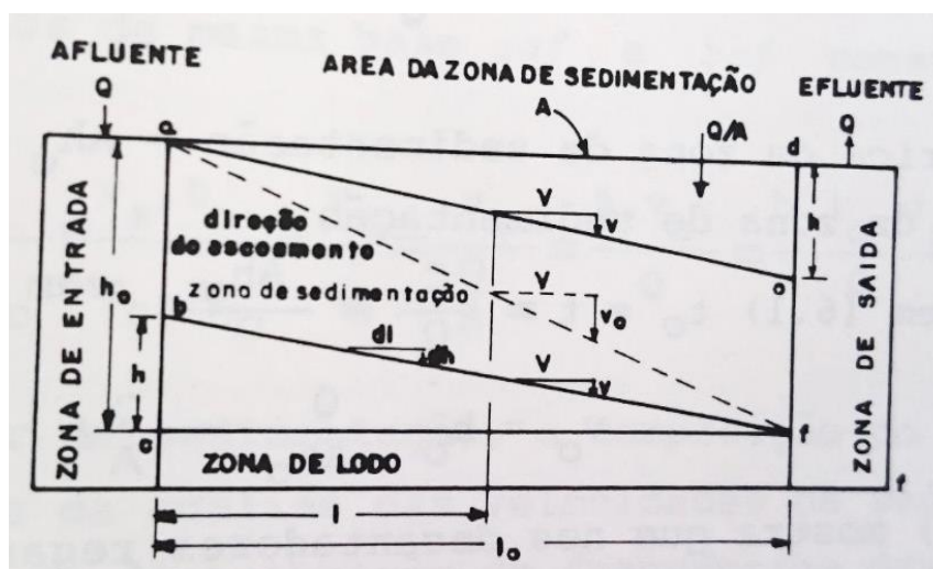
Figura 05 – Seção vertical – longitudinal do decantador retangular
