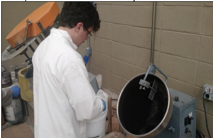
Figura 13 - Prato peletizador utilizado na elaboração do combustível
