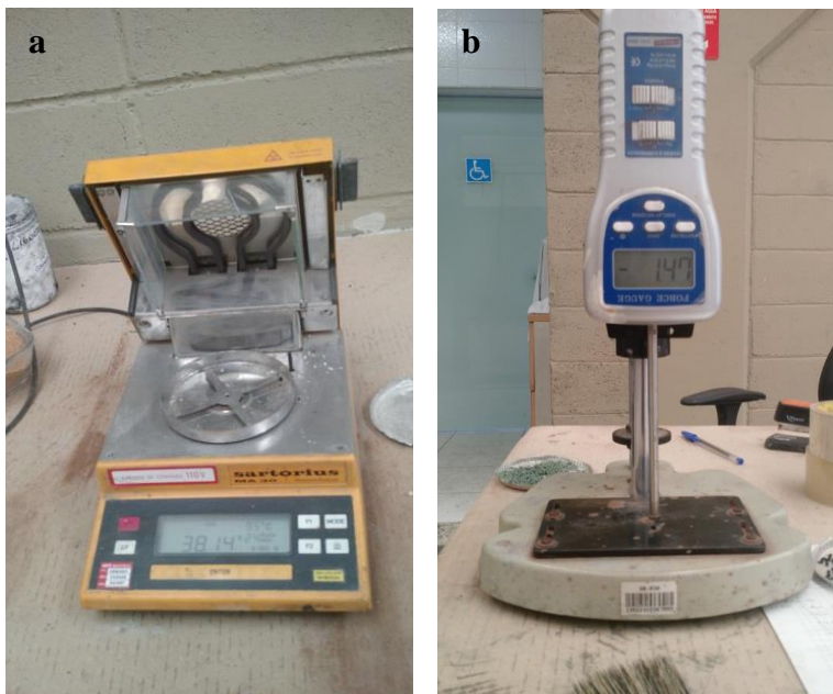
Figura 14 - Equipamentos utilizados durante a granulação dos combustíveis, onde: a) analisador de umidade; b) medidor de resistência
