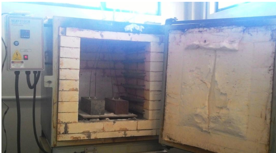
Figura 5: Corpos de prova com termopares dentro do forno
