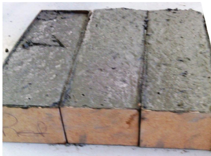
Figura 3: Corpos de prova de concreto convencional
