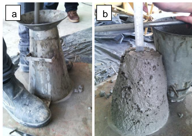
Figura 6 – Realização de Slump Teste
