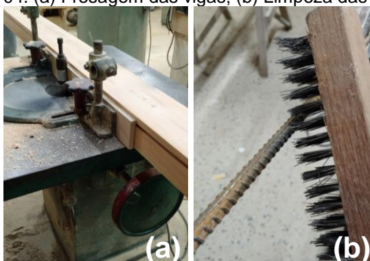
Figura 04: (a) Fresagem das vigas; (b) Limpeza das barras;
