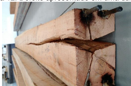
Figura 12: Defeito apresentado em uma das vigas
