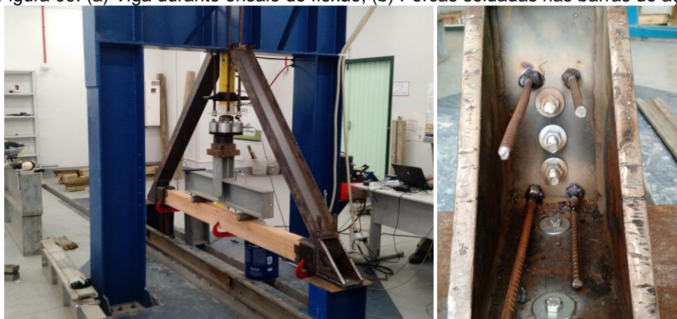
Figura 09: (a) Viga durante ensaio de flexão; (b) Porcas soldadas nas barras de aço
