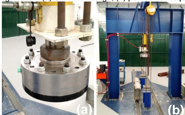
Figura 08 – (a) Célula de carga; (b) pórtico de reação
