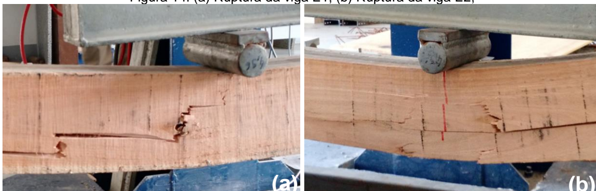
Figura 14: (a) Ruptura da viga E1; (b) Ruptura da viga E2;
