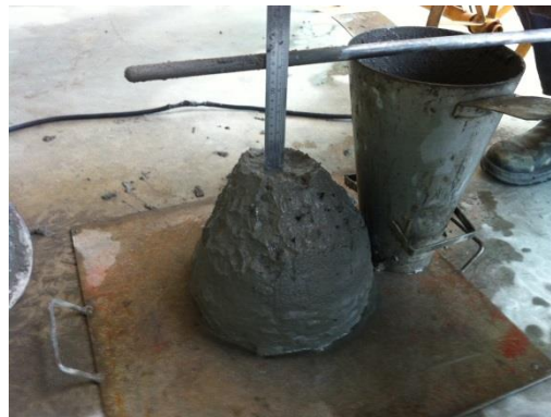
Figura 5 – Ensaio de abatimento de tronco de cone ( Slump Test ).
