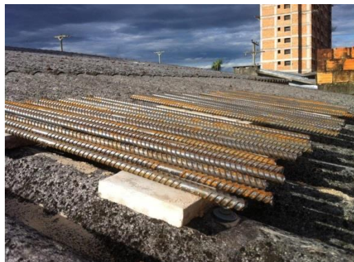
Figura 2 – Forma de exposição do aço a intempéries.
