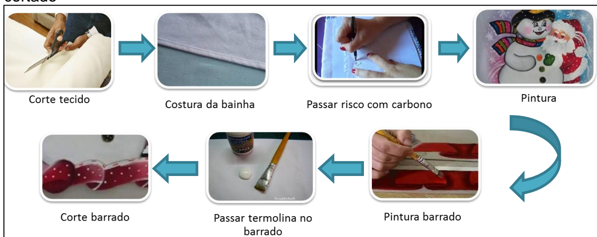
Figura 9 - Fluxograma do processo produtivo da toalha de louça com barrado cortado
