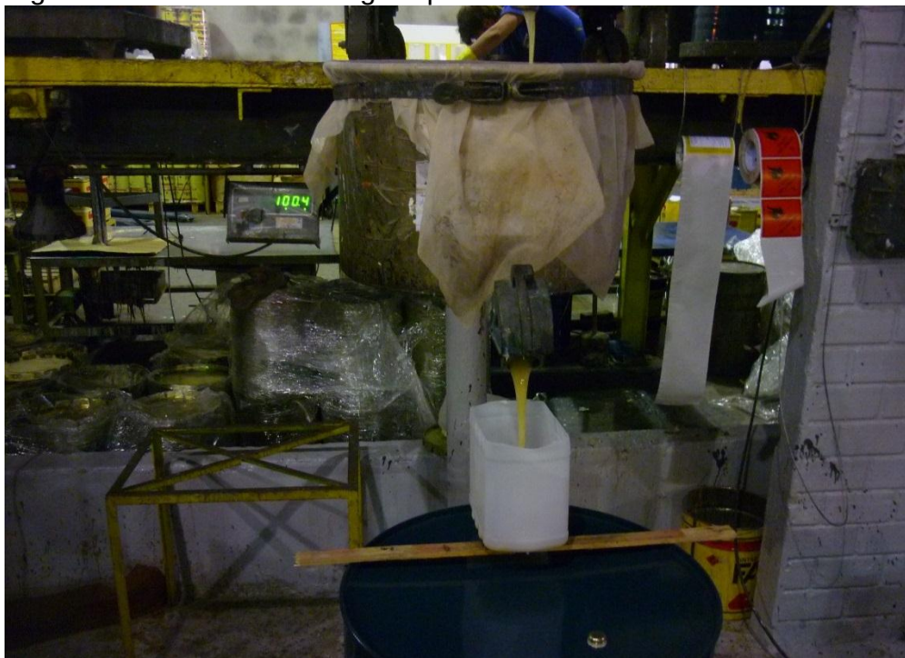
Figura 13: Método de filtragem por malhas.
