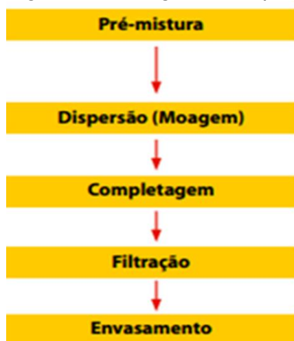
Figura 1: Fluxograma do processo de fabricação de tintas.
