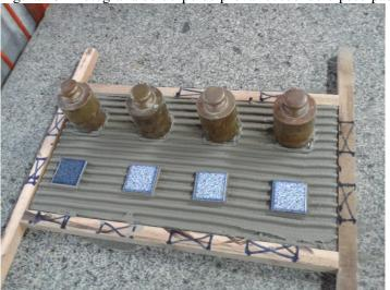
Figura 10 - Fotografia do corpo de prova recebendo o peso padrão.
