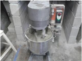
Figura 8 - Misturador planetário utilizado no preparo da argamassa.
