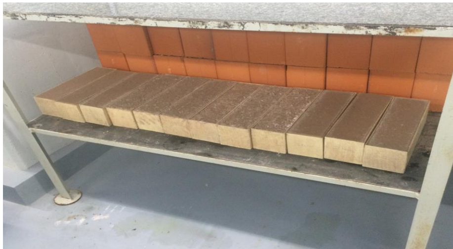
Figura 3 – Corpos de prova em processo de cura.
