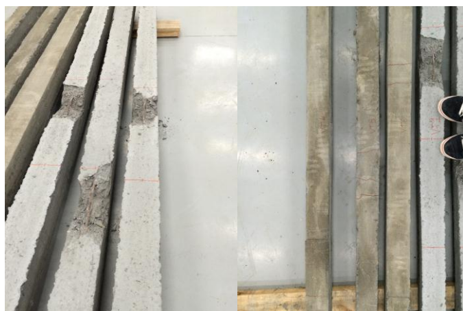
Figura 14: Aspecto das vigotas treliçadas de 3,00 e 5,00 metros após o ensaio
