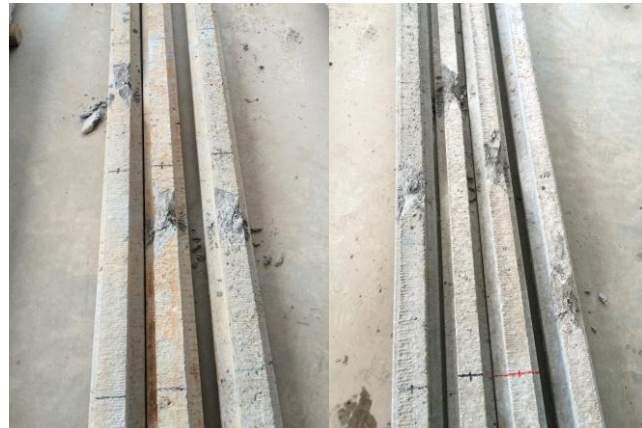
Figura 11: Aspecto das vigotas protendidas de 3,00 e 5,00 metros após o ensaio.
