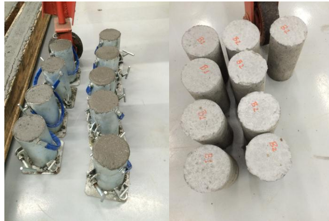
Figura 7: Corpos de prova moldados para Ensaio de Compressão Axial
