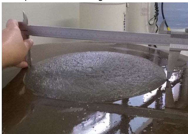
Figura 02: Medição do espalhamento da argamassa
