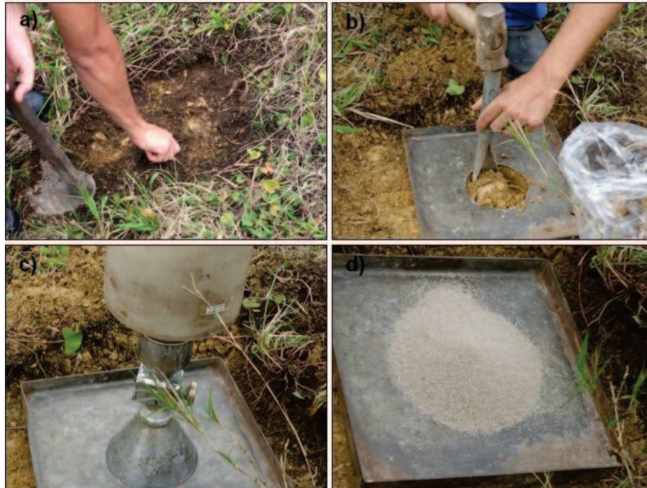
Figura 11 a-d) - Ensaio de densidade in situ realizado na área em processo de reabilitação ambiental.
