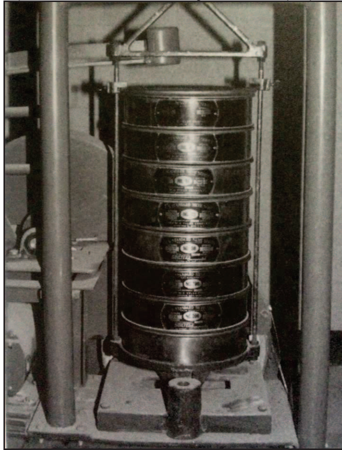
Figura 05 - Conjunto de peneiras utilizadas em ensaio granulométrico por peneiramento.
