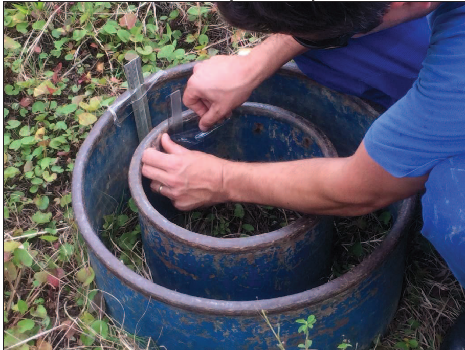
Figura 15 - Instalação dos anéis concêntricos e régua de medição.
