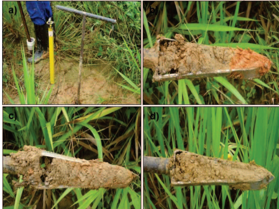
Figura 17 - Determinação da espessura da camada de solo com trado manual (a, b, c, d).
