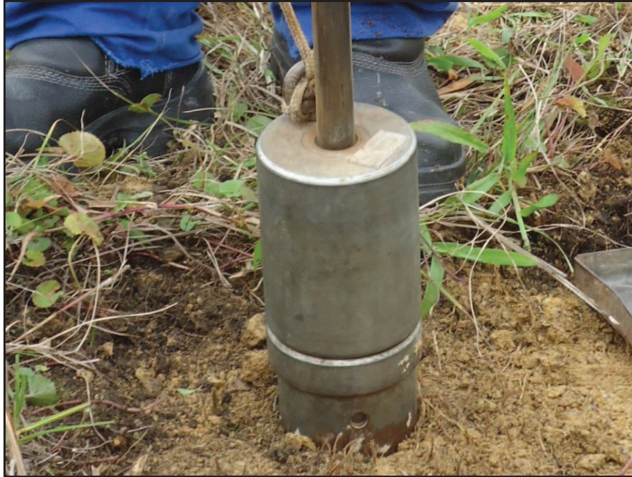
Figura 10 - Coleta de amostra indeformada de solo na área em processo de reabilitação encaminhada para ensaio de permeabilidade.
