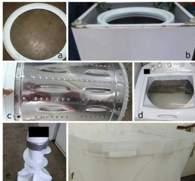
a. Anel hidro. b. Gabinete. c. Cesto. d. Painel. e. Agitador. f. Tanque
