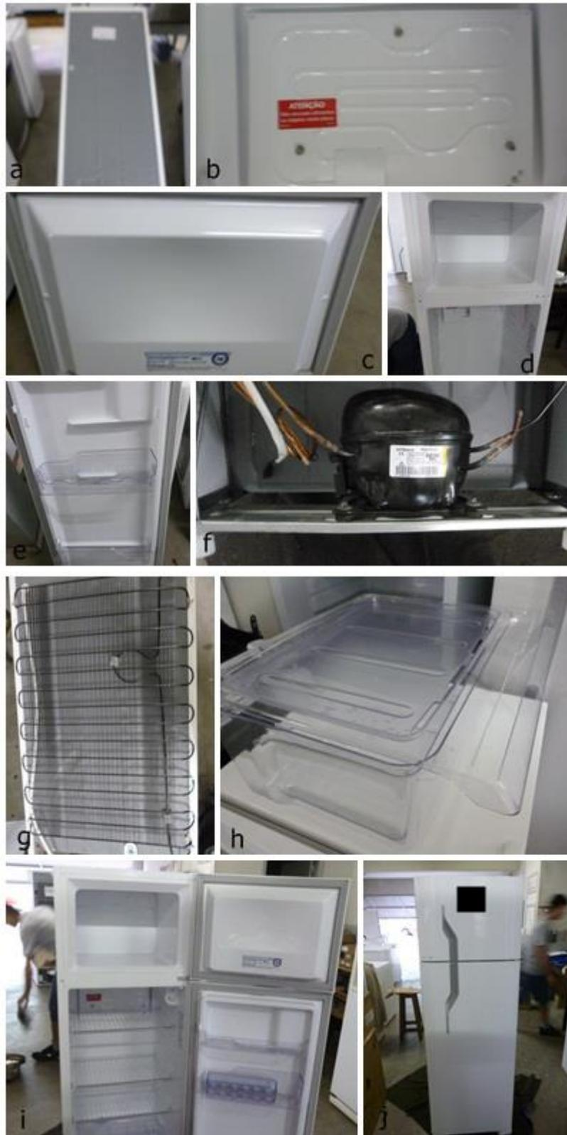
a. Gabinete. b. Evaporador. c. Porta do congelador. d. Gabinete vista interna. e. porta do refrigerador. f. Compressor. g. Condensador. h. Gaveta. i. Refrigerador vista interna. j. Refrigerador.
