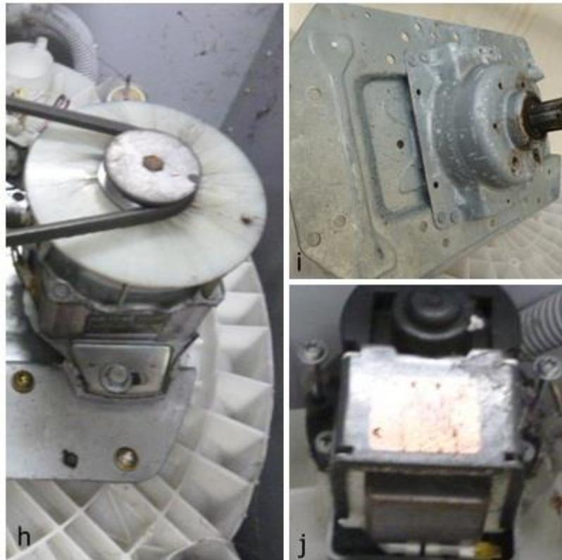
h. Motor. i. Conjunto mecanismo. j. Bomba de drenagem.
