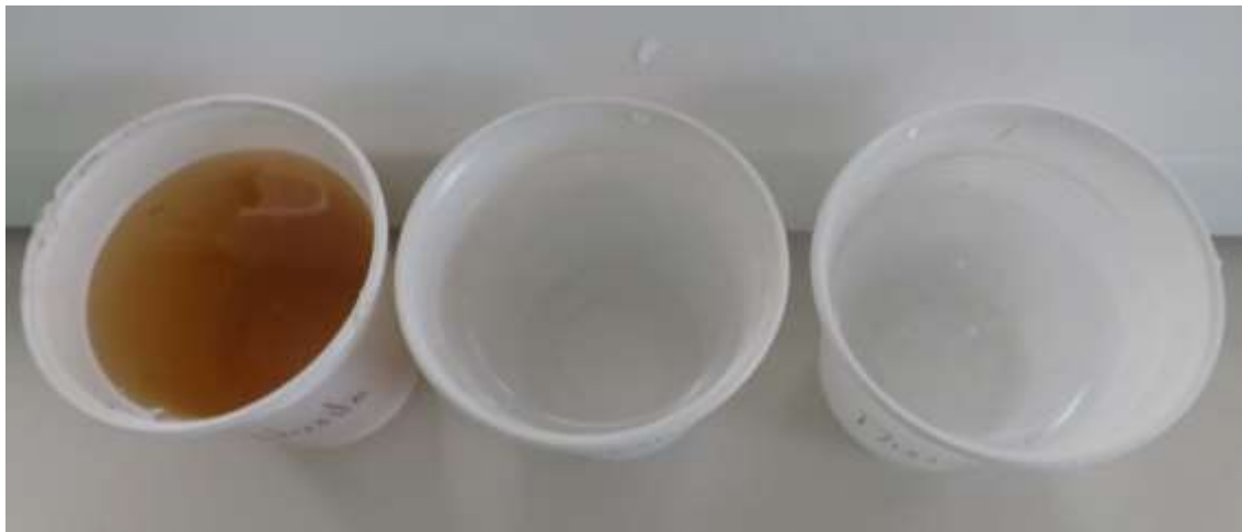
Figura 6 - Ilustração dos reagentes. PAC sem diluição (a), PAC diluído a 1% (b) e o polímero diluído a 0,1% (c)
