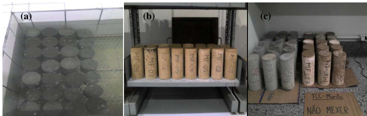
Figura 2 – CC em cura (a), armazenamento CG até os 28 dias (b), amostras em sala com temperatura controlada (c).
