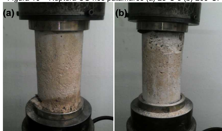
Figura 10 – Ruptura CG nos patamares (a) 23°C e (b) 200°C.
