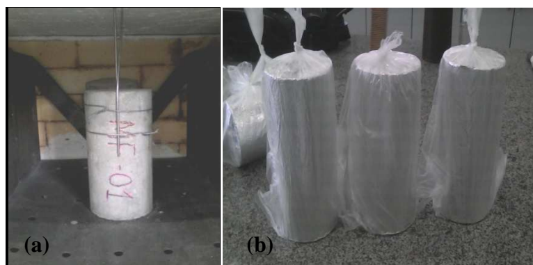
Figura 5 – Disposição dos termopares(a); Amostras armazenadas após exposição à alta temperatura(b).
