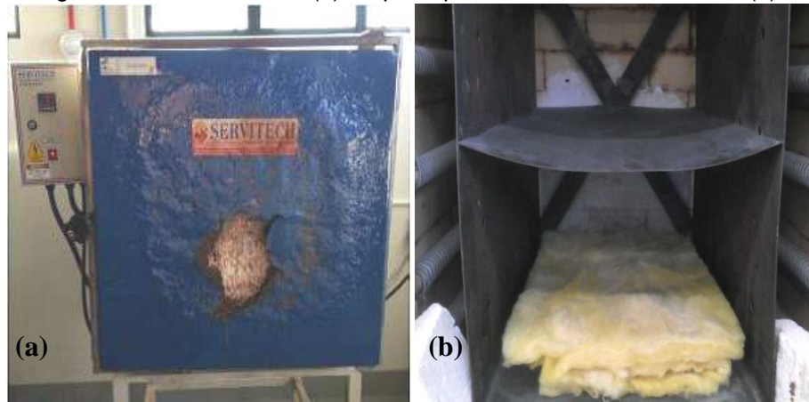
Figura 4 – Forno utilizado (a); Suporte para os CPs dentro do forno (b).
