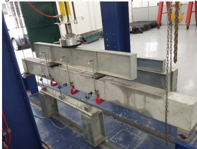
Figura 09: cilindro hidráulico e LVDT's posicionados na viga
