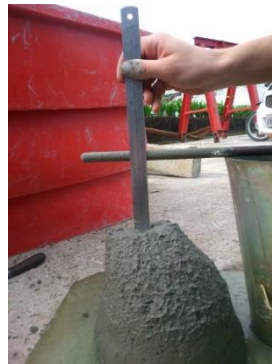
Figura 6: Ensaio de abatimento ( slump test )
