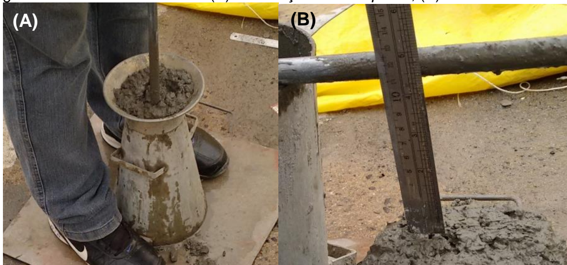
Figura 7: Abatimento de cone - (A) Realização do slump-test , (B) Resultado.
