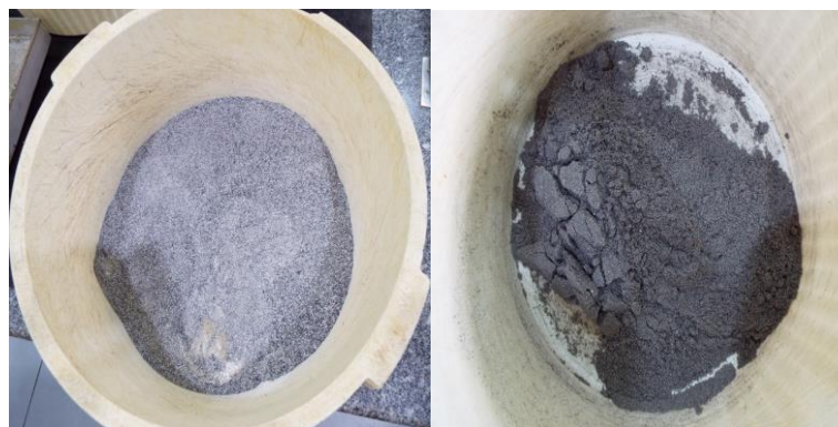
Figura: Mistura solo-CCA-cal. a) Estado seco. b) Estado saturado.
