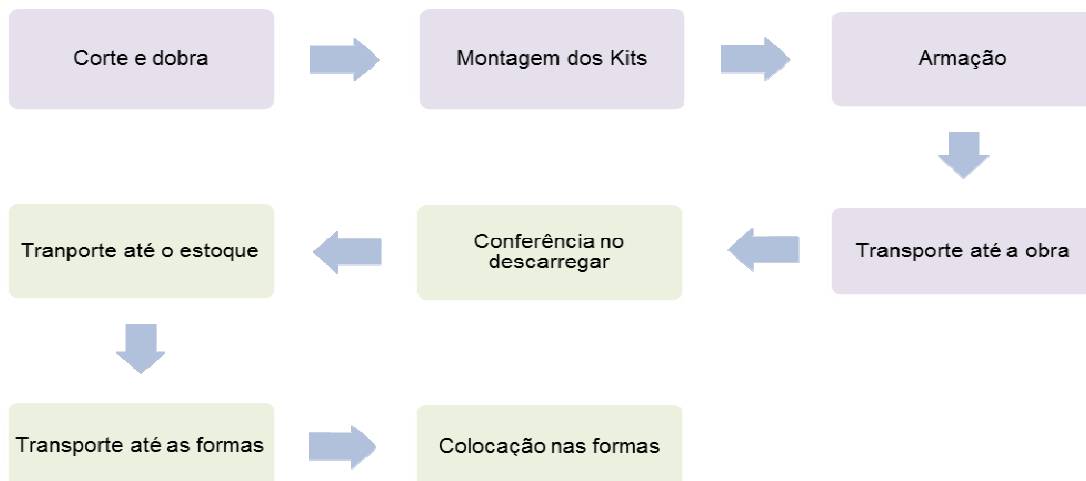
Figura 3: Método industrializado (corte, dobra e montagem) Projeto C.
