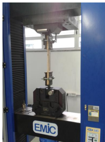
Figura 05: Ensaio de tração paralela às fibras
