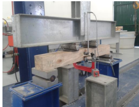
Figura 03: Ensaio de flexão estática a quatro pontos.
