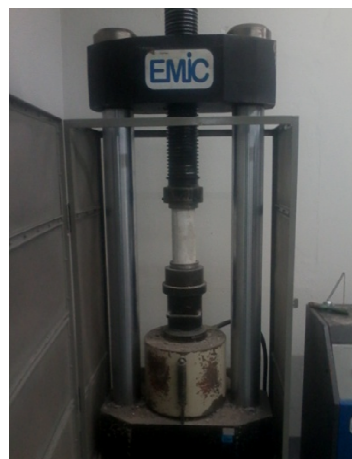
Figura 9 - Ensaio Compressão axial.
