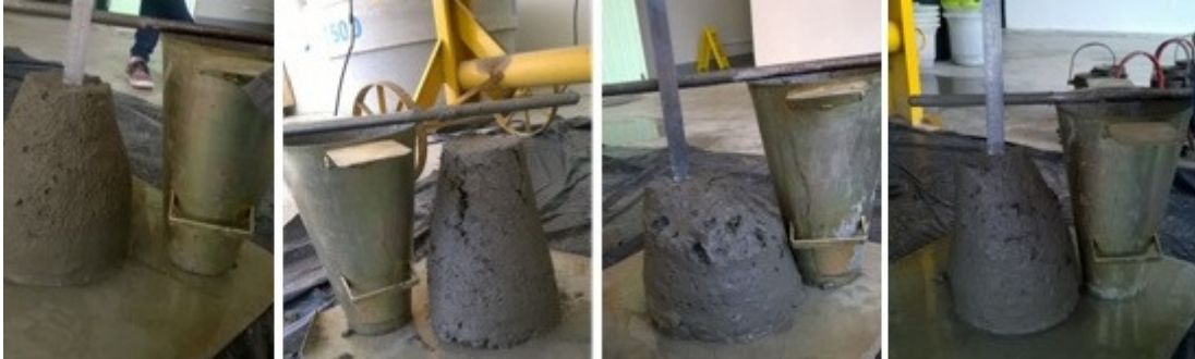
a) Traço 01 - Abatimento 9 cm. b) Traço 02 - Abatimento 4 cm. c) Traço 03 - Abatimento 12 cm. d) Traço 04 - Abatimento 7 cm.
