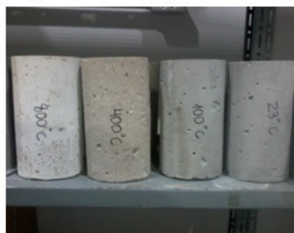
b) Mudança de coloração nos concretos após aquecimento
