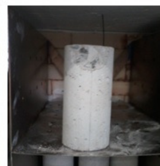
c) Corpo de prova sem fibra ( spalling )
