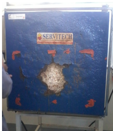
Figura 6 - Mufla utilizada no aquecimento dos corpos de prova.
