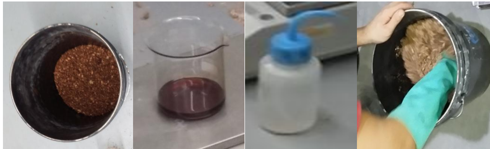
Figura 3 – Materiais e mistura: (a) partículas de madeira; (b) resina FF-109; (c) água; (d) mistura.
