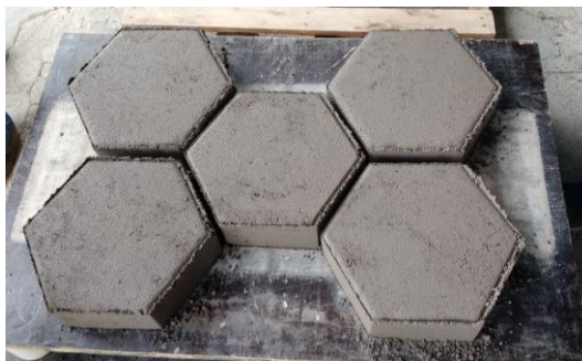
Figura 01 – Peças de concreto após moldagem.
