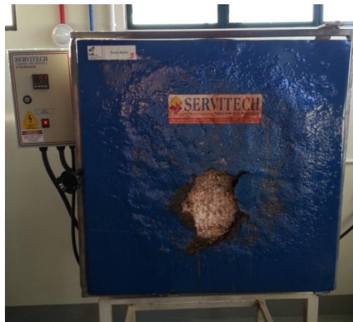
Figura 7 – Mufla utilizada para o aquecimento dos corpos de prova
