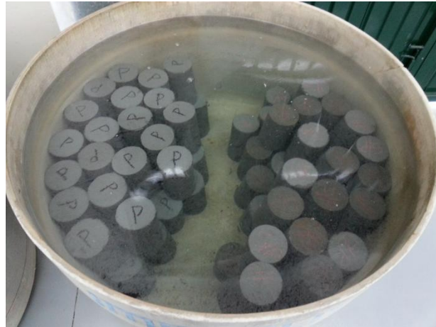
Figura 5 – Corpos de prova em processo de cura
