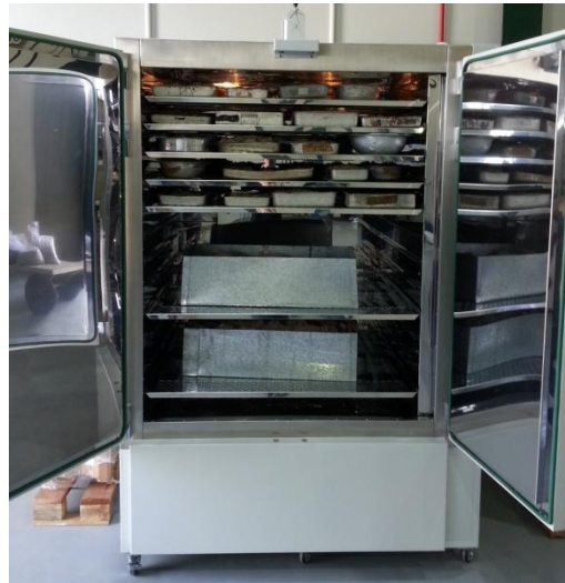
Figura 2 – Estufa para secagem dos agregados
