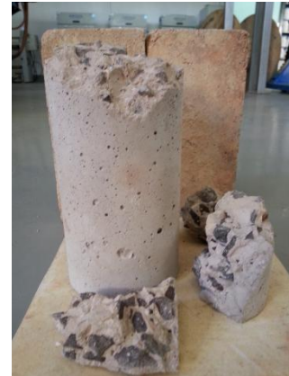
b) Corpo de prova de referência ( spalling )
