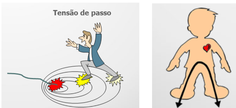
Figura 10 - Imagem das linhas de tensão e choque elétrico por tensão de passo. Autor: Comissão Tripartite Permanente de Negociação do Setor Elétrico no Estado de SP
