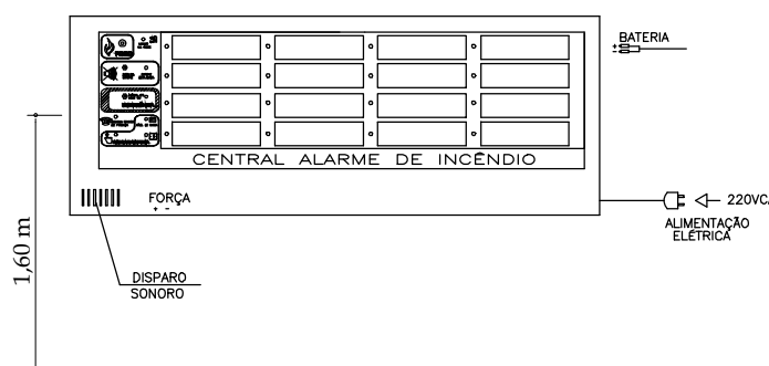
Detalhe 05 - Centra de Alarme de Incêndio SEM ESCALA
