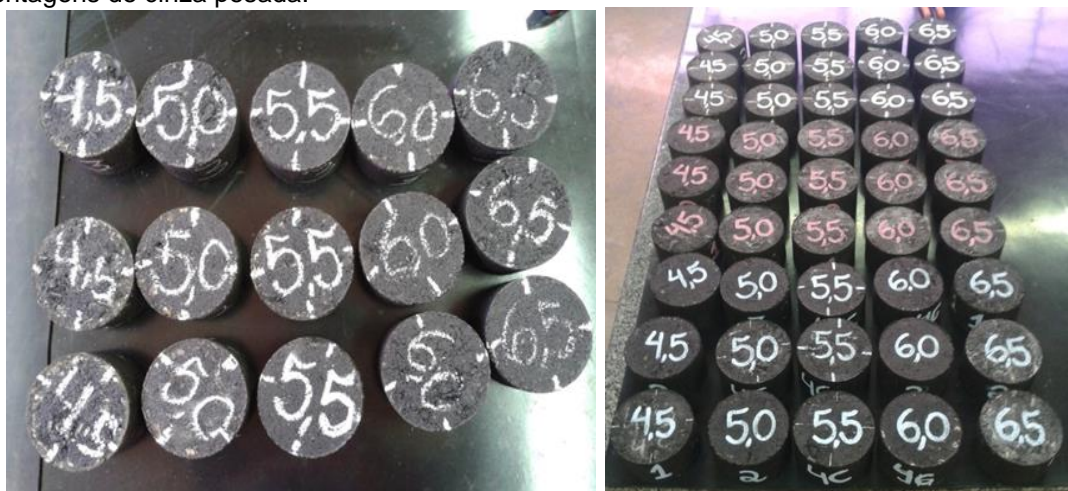
Figura 5 – Corpos de prova moldados segundo a metodologia Marshall: a) corpos de prova da mistura de referência (REF), sem adição de cinza pesada e (b) corpos de prova com diferentes porcentagens de cinza pesada.
