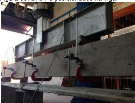
Figura 08: LVDT's posicionados na viga.
