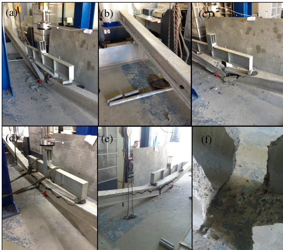
Figura 12: Comportamento das terças na ruptura - a) Terça A1; b) Detalhe do rompimento da terça A1; c) Terça A2; d) Terça B1; e) Terça B2; f) Detalhe do rompimento do aço na terça B2.
