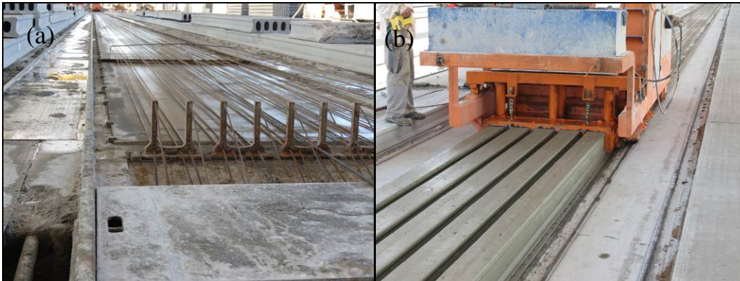
Figura 4: Etapas de produção das terças – a) Pista com os fios já protendidos; b) Concretagem da pista de terças.
