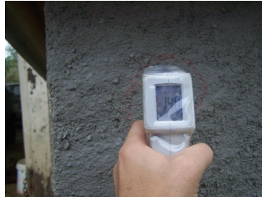
Figura 18 – Medição das Paredes Externas as 8:00h .
