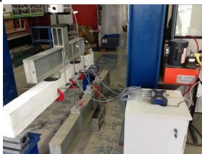
Figura 8: Viga posicionada para o início do ensaio de flexão.
