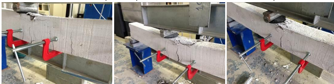
Figura 17 – Fissuras no Grupo 01, para as amostras A, B e C, respectivamente.
