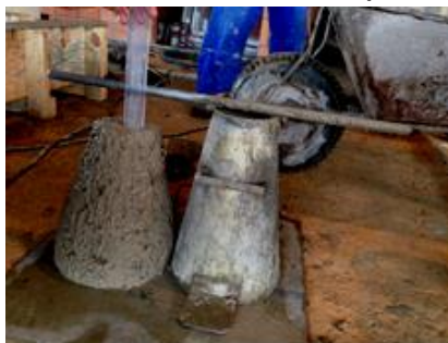
Figura 11 – Medida do abatimento através do Slump-Test após 240 minutos.
