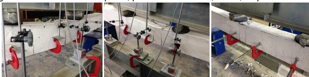
Figura 19 – Fissuras no Grupo 03, para as amostras A, B e C, respectivamente.
