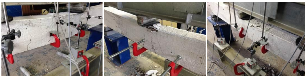
Figura 18 – Fissuras no Grupo 02, para as amostras A, B e C, respectivamente.
