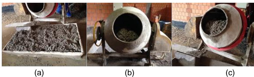
Figura 4: (a) Caixa de madeira contendo toda a mistura de concreto utilizada. (b)(c): Betoneiras onde o concreto permaneceu durante o experimento.
