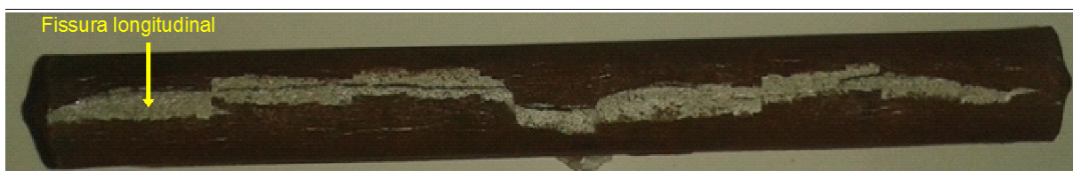
Figura 09: Trinca na amostra de 8,00 mm de espessura
