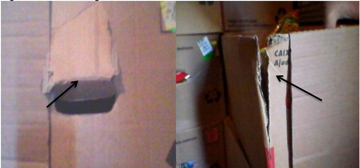
Figura 11 - Caixas rasgadas devido ao manuseio incorreto
