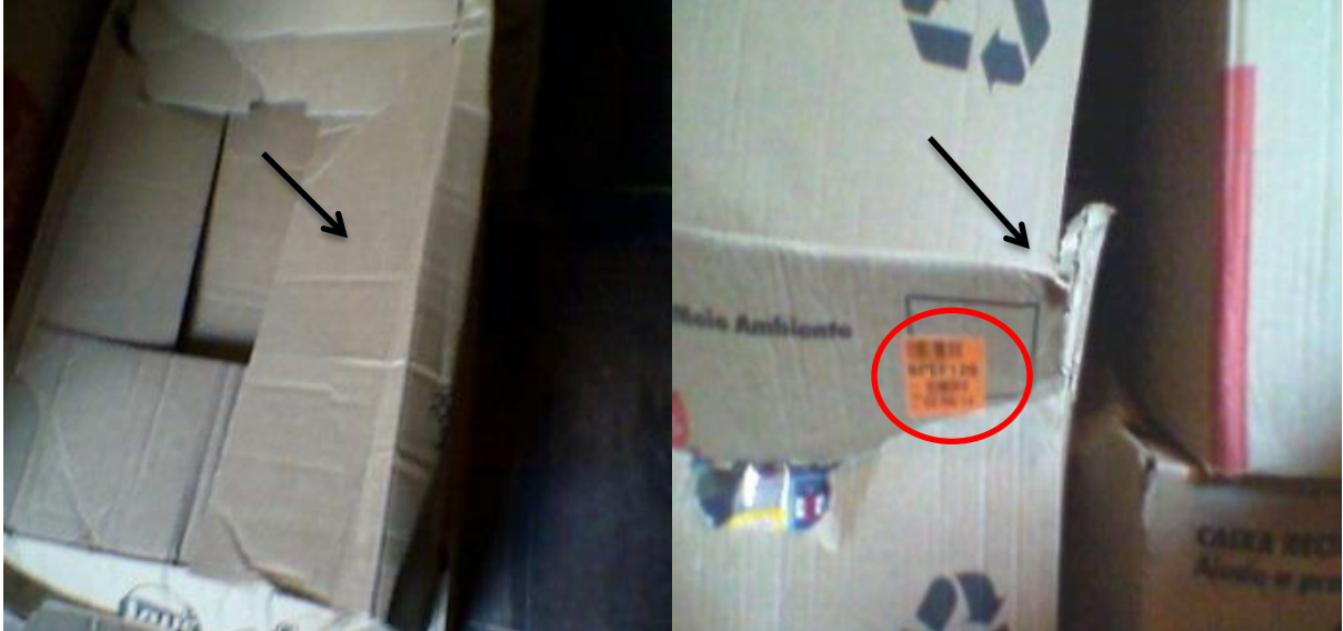
Figura 10 - Caixas que cederam por pressão de peso
