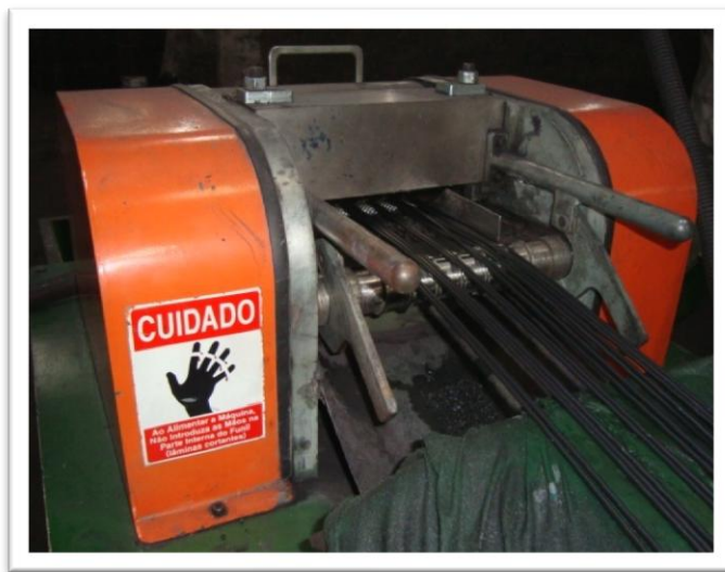
Figura 14: Processo de Granulometria do Material Reciclado
