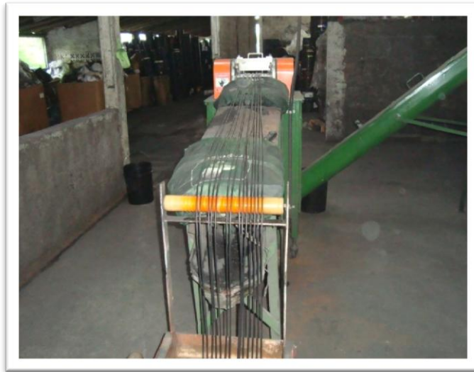
Figura 13: Processo de Resfriamento do Material Extruzado
