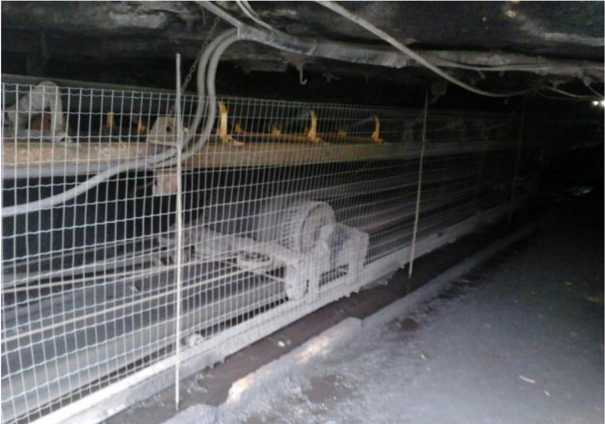
**Foto 04:** Proteções em partes móveis da correia transportadora. **Fonte:** Do autor.
