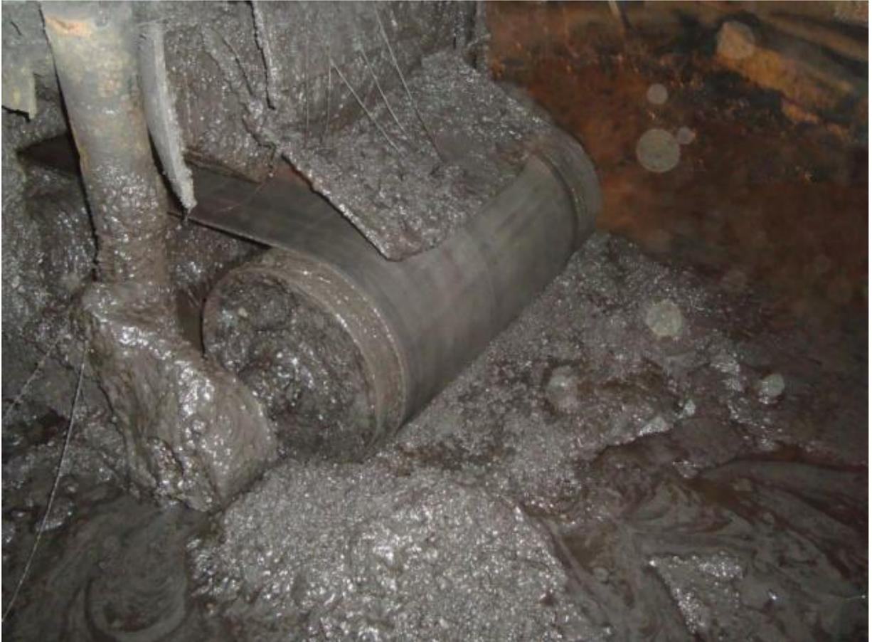
**Foto 08:** Rolo de correia transportadora sem proteção. **Fonte:** Do autor.
