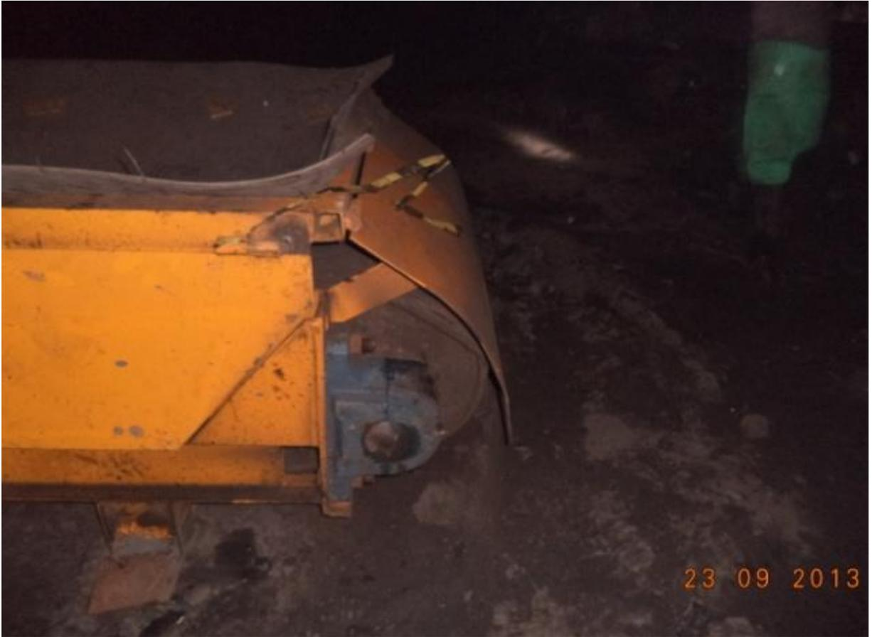
**Foto 09:** Rolo da cauda de correia transportadora com proteção tipo chapa. **Fonte:** Do autor.
