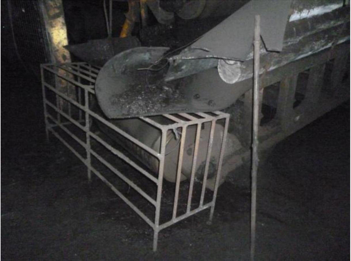
**Foto 10:** Rolo de cauda de correia transportadora com proteção tipo trave. **Fonte:** Do autor.
