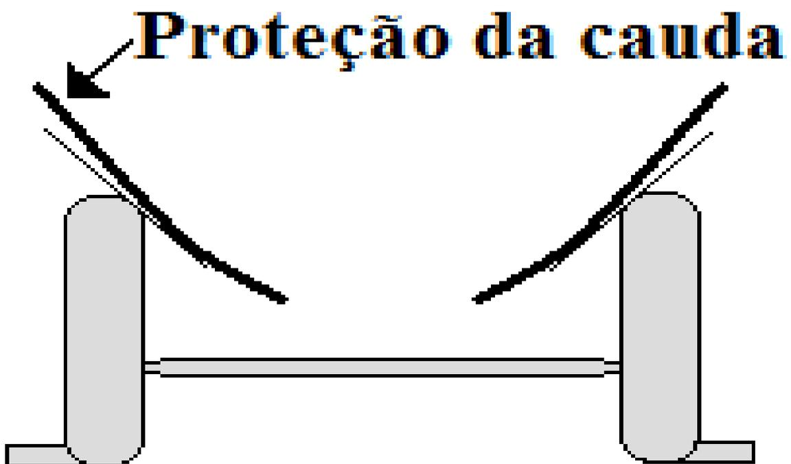
**Figura 14:** Proteção da cauda de correia transportadora. **Fonte:** Do autor.
