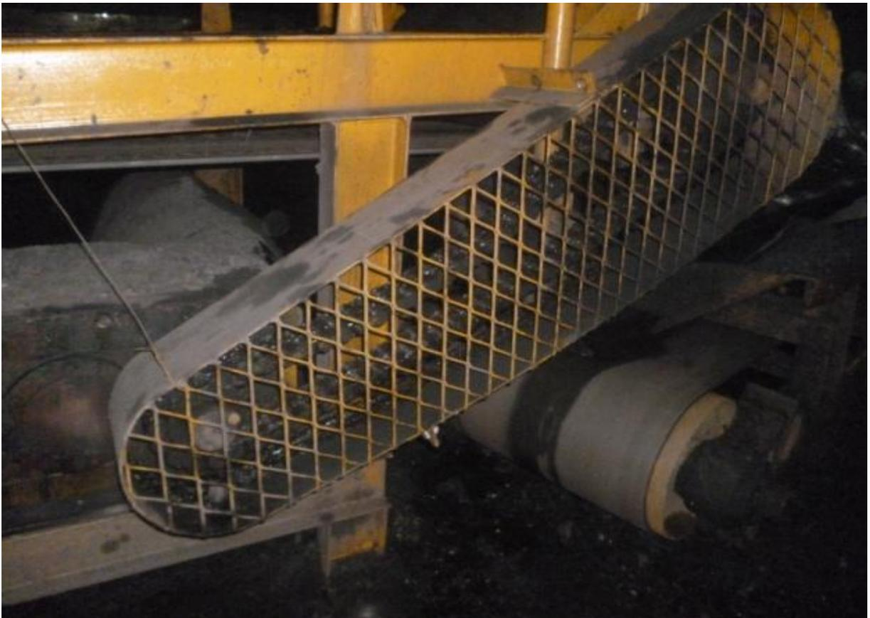
**Foto 06:** Proteção da corrente ASA 120 do cabeçote de correia. **Fonte:** Do autor.
