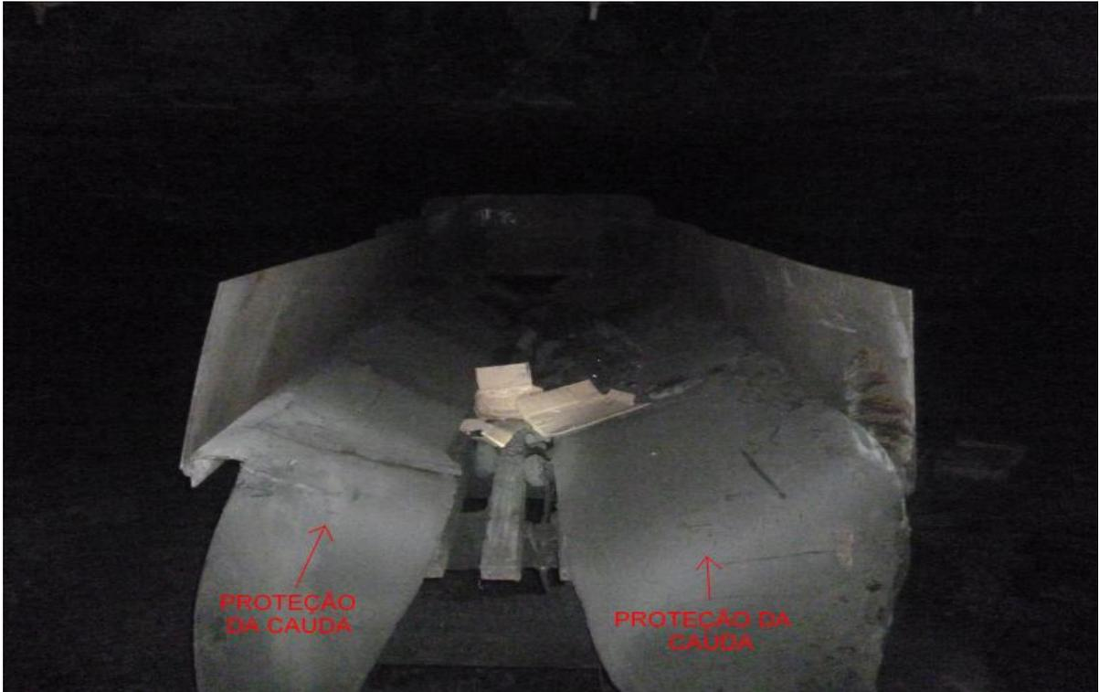
**Foto 14:** Proteção da cauda de correia transportadora. **Fonte:** Do autor.
