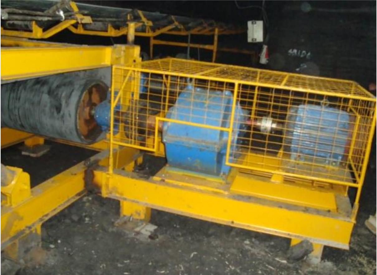
**Foto 01:** Proteção em acionamentos e componentes girantes. **Fonte:** Do autor.
