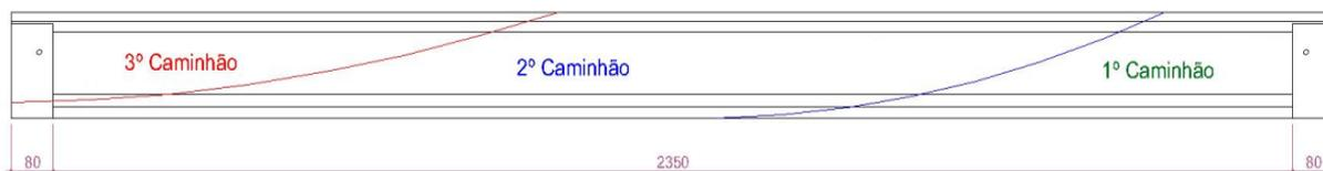
Figura 12 – Rastreabilidade do concreto utilizado na execução da viga número 02.
