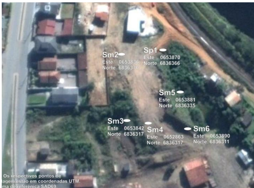
Figura 03 - Locação dos furos de sondagem.
