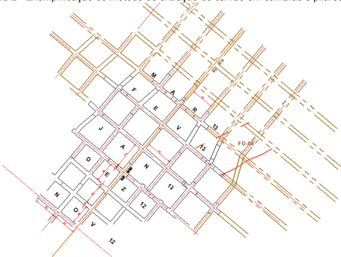
Figura 2 - Exemplificação do método de extração de carvão em câmaras e pilares.
