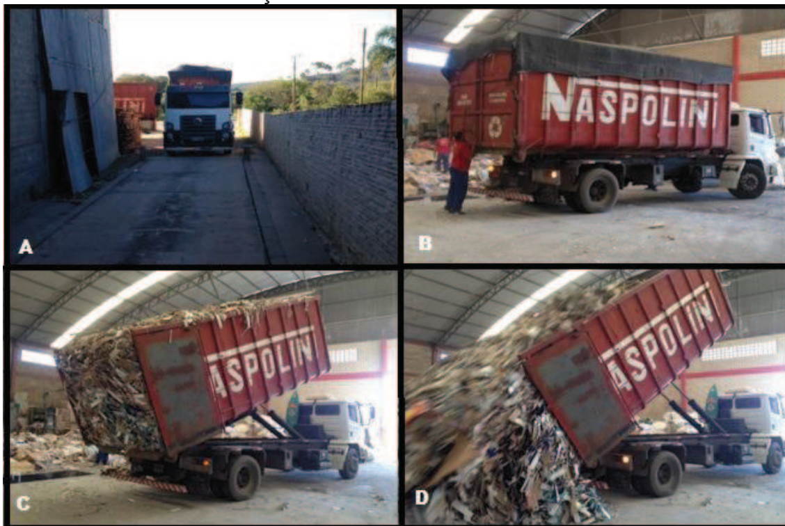
Figura 15 Etapas de descarga de material para triagem – A – Pesagem do Material; B – Retirada da lona e abertura das portas; C – Basculando o caminhão; D – Retirada do material da caçamba.
