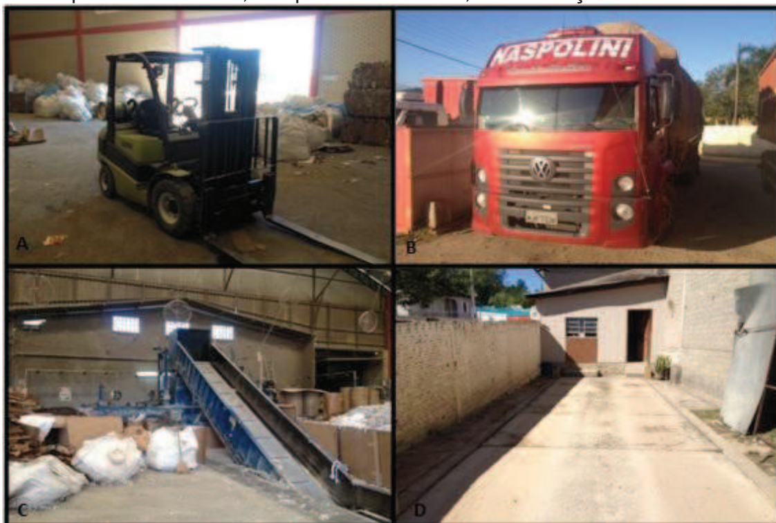
Figura 13 - Equipamentos adotados pela empresa: A – Empilhadeira; B – caminhão com capacidade de 23 T; C – prensa horizontal; D – Balança eletrônica.
