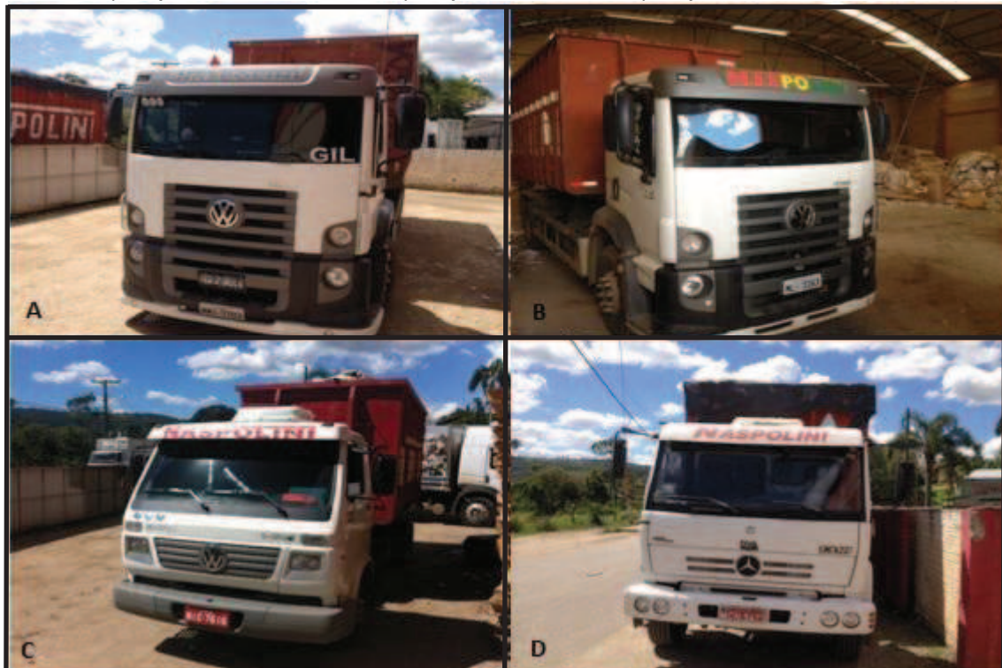
Figura 12– Caminhões para transportes utilizados na empresa: A) capacidade de 13,2 t; B) capacidade de 16 t; C) capacidade 9 t; D) capacidade 13 t
