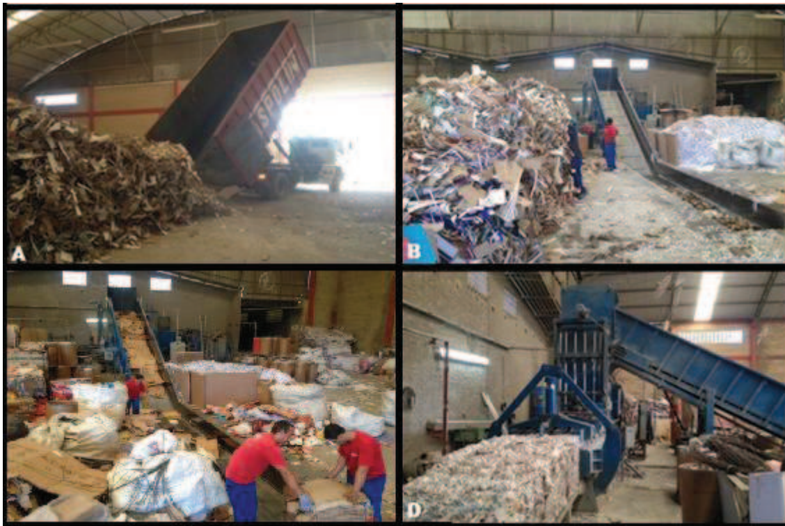
Figura 16 - Operação de descarga, prensa e enfardamento: – A – Caminhão descarregado; B – Material para ser classificado; C – Material na esteira da prensa; D – Fardo concluído.
