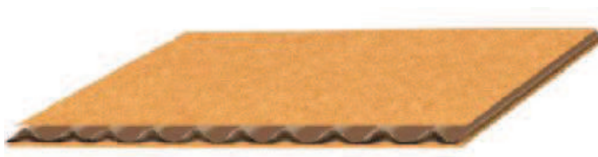
Figura 8 – Papel ondulado de parede simples
