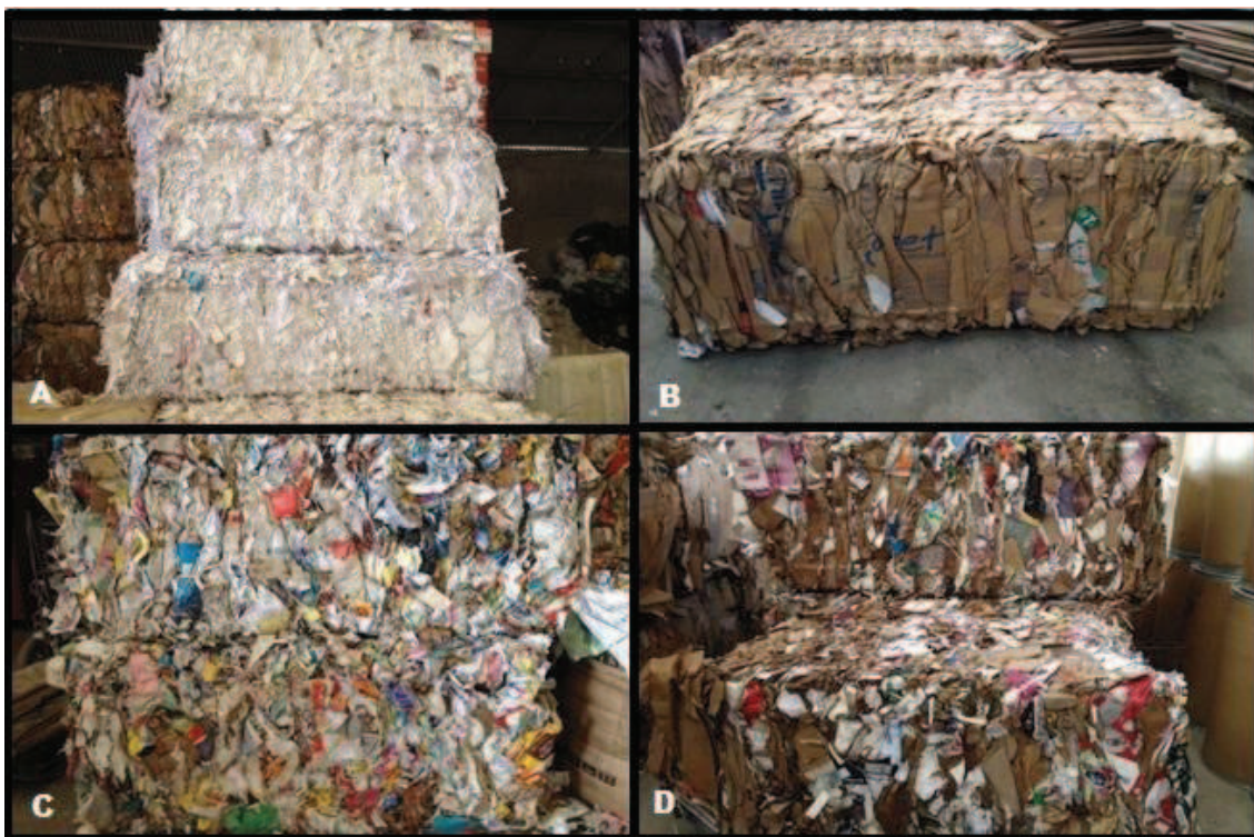
Figura 24 – Material triado e prensado para expedição: A – Fardo de papel branco; B – Fardo de ondulado I; C – Fardo de papel misto; D – Fardo de papel ondulado III.
